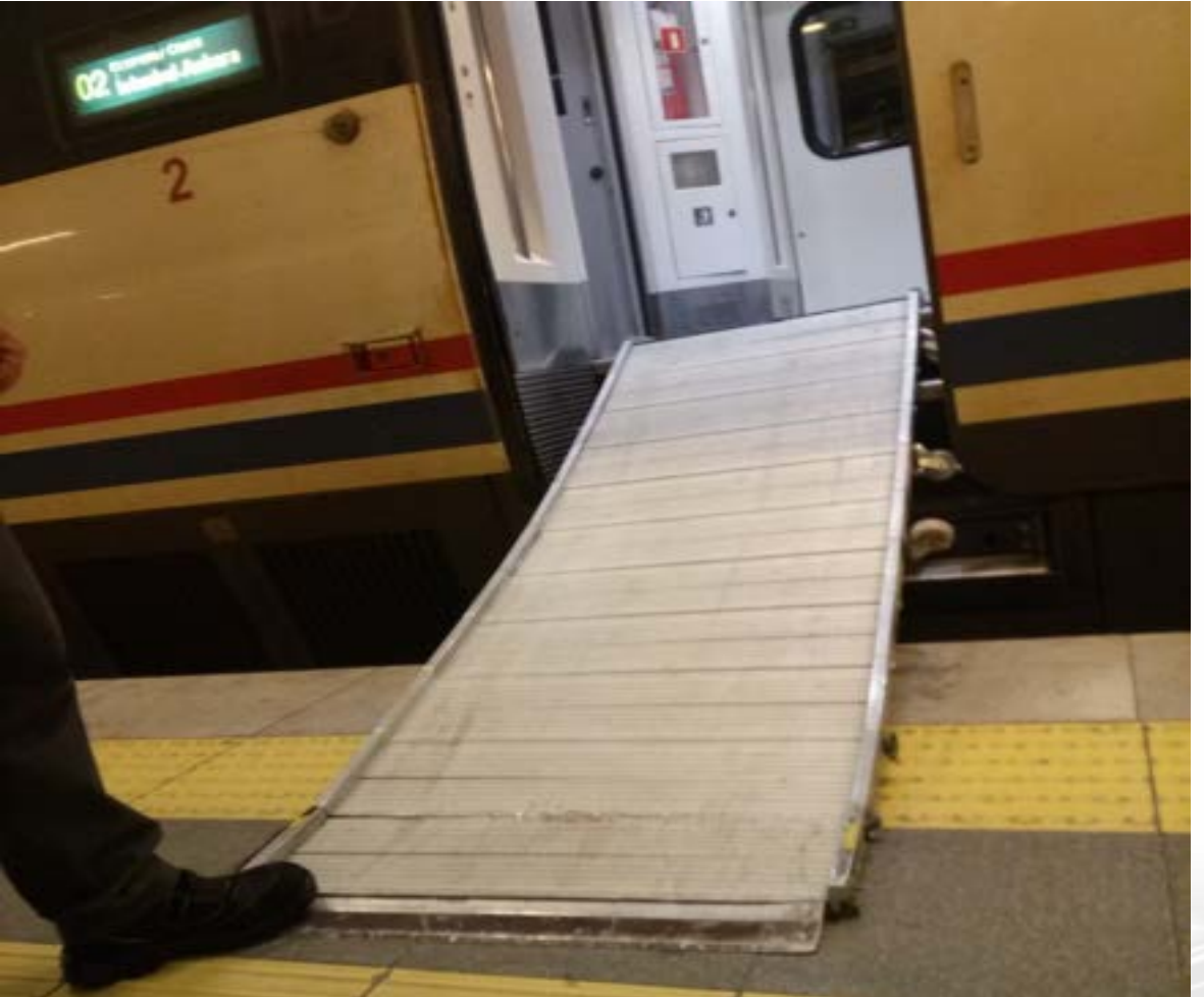
Fotoğraf 26 TCDD Ankara Gar, Yüksek Hızlı Tren 2 numaralı vagon girişi, tekerlekli sandalye için rampa.
