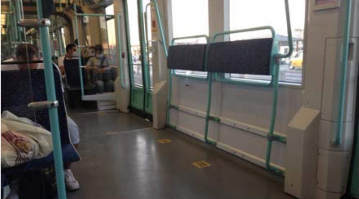
Fotoğraf 5. İstanbul hafif raylı sistemde tekerlekli sandalye kullanıcıları ve bebek arabalı bireyler için ayrılmış alan, aynı zamanda ayakta duran bireylerin seyahat sırasında yaslanması için de uygun düzenleme yapılmış.
